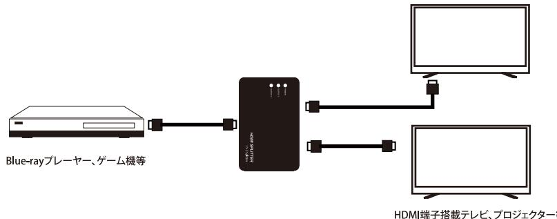
2 台の HDMI 端子搭載テレビ、プロジェクター等に同じ映像と音声が出力されます。
