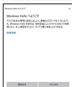
指紋のスキャンを求められますので、本製品をPCのUSBに接続し、登録したい指紋を画面の表示に従って、センサーにタッチして、スキャンして下さい。
